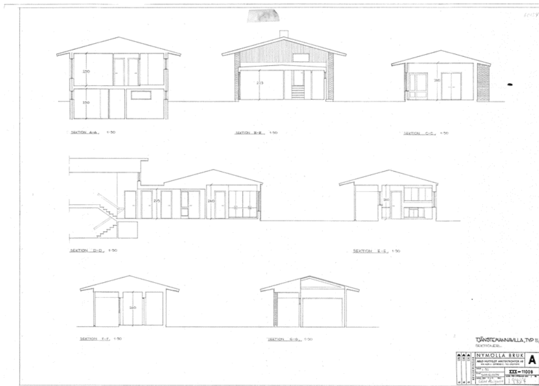
Sektionsritning till tjänstemannavilla. Halvtrapporna till sovrumsavdelningen respektive källaren skapar kommunikation mellan villans olika delar.
