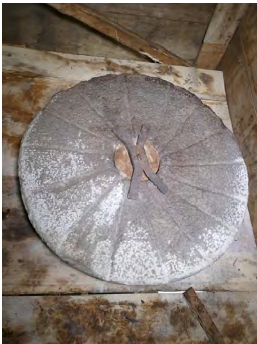
Kvarnstenarnas nedslitna partier högs om. Här buggs ny yta på liggaren. När möllan var igång var detta något som gjordes varje år.
