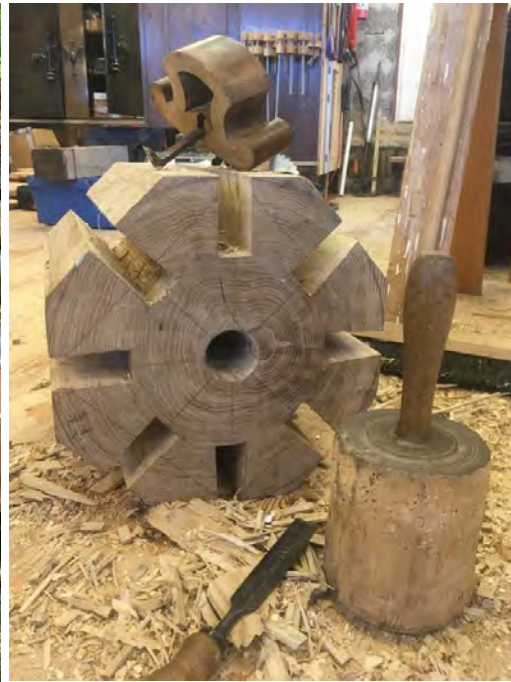
T. v: Det befintliga skovelhjulet underst och det som timmerman Jens Ingvad håller i är från 1970. T. h: Det nya skovelhjulet tillverkades av virke från den ek som stått intill möllan. Foto Jens Ingvad.
