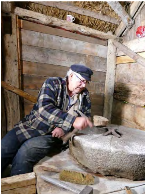
Kvarnstenarnas nedslitna partier högs om. Här buggs ny yta på liggaren. När möllan var igång var detta något som gjordes varje år.
