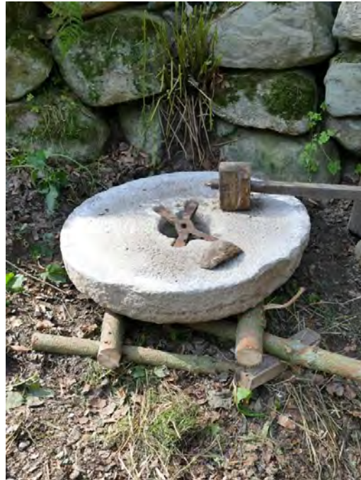
Kvarnstenarna (liggaren t.v. och löparen t. h.) togs ut och undersöktes. I löparen sitter fyrgrenskorset som driver stenen. Det gamla lagret, träklossen, som håller axeln på plats och som sitter i liggaren, ses på löparen.
