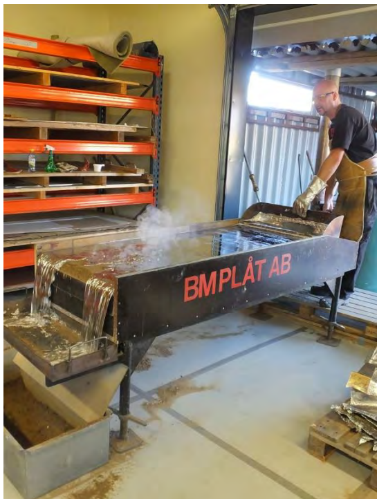
T. v: Gjutning av nya blyplåtar i plåtfirmans verkstad. T. h: Blyplåten med plåtfirmans stämpel rullas ihop.
