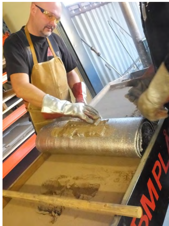
T. v: Gjutning av nya blyplåtar i plåtfirmans verkstad. T. h: Blyplåten med plåtfirmans stämpel rullas ihop.
