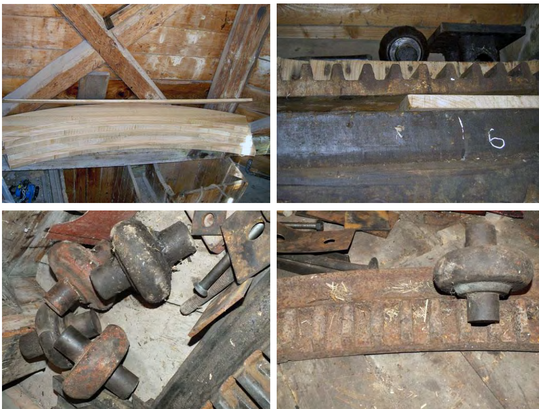
Ovan till vänster syns bitar av den nytillverkade lejden av ek, som väntar på att monteras. Ovan till höger en detalj, där en del av den nya lejden just kommit på plats. Fotona ovan är tagna av Bo Larsson, Föreningen Övraby mölla. Nedan till vänster syns rouletter som tagits tillvara från andra möllor, för att kunna utgöra ett reservdelslager. Nedan till höger visas principen för hur rouletterna löper på vridkranen, rälsen.
