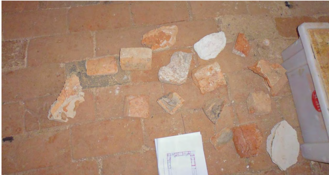
Fig. 10. Material från borrhärna tagen ur medeltida mur, se fig. 8, nr 5.
