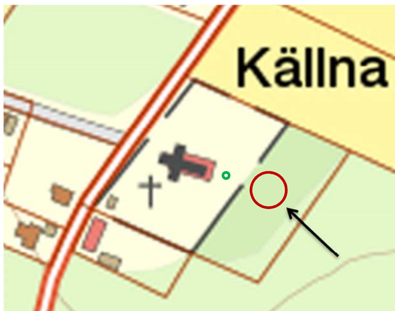
Grön markering visar brunnen, där dräneringsrör och stuprören möts. Röd markering visar stenkestans placering.
