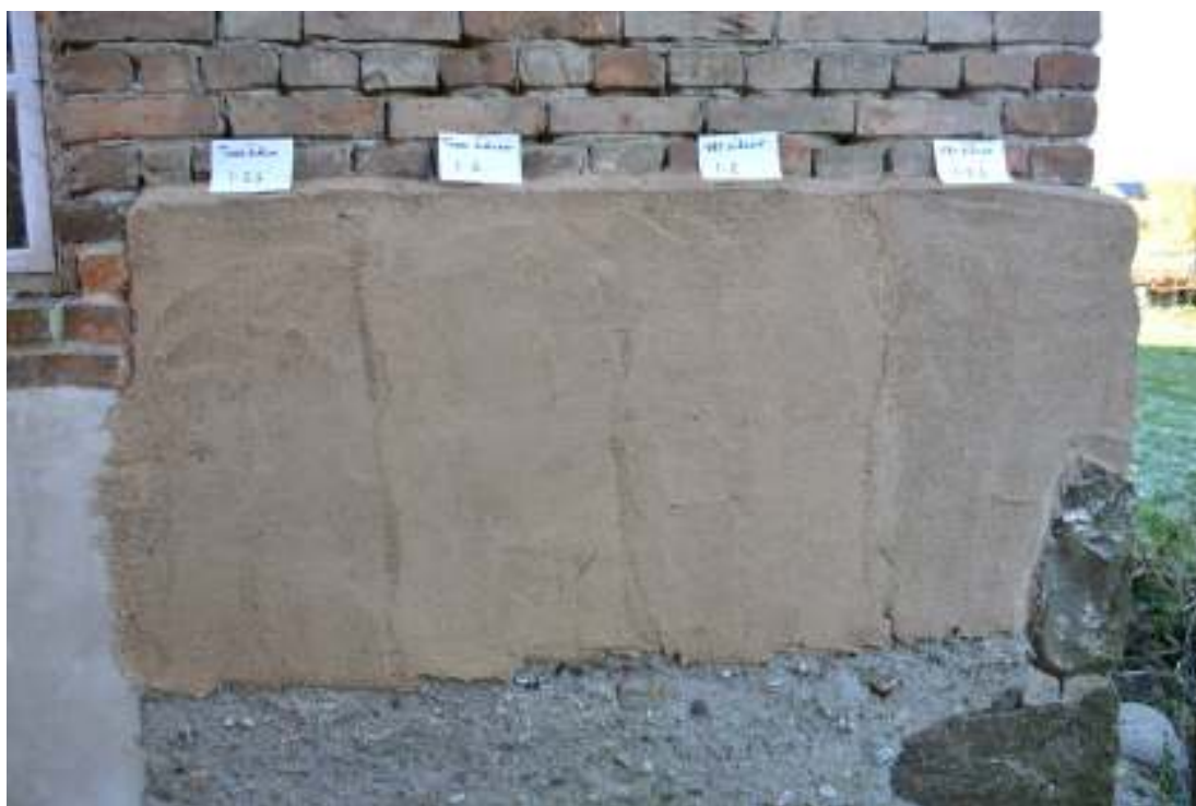
Putzprover, från vänster: torrsläcket 1:2,5, torrsläcket 1:2, våtsläcket 1:2, våtsläcket 1:2,5. Foto Henrik Nilsson
