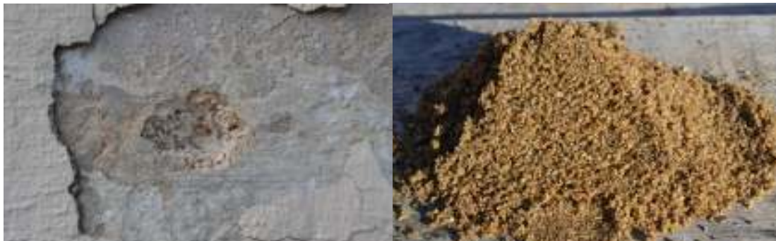
T.v. Referensbruk på huvudbyggnad på Bollerups borg, Tomelilla, från senast 1920-tal. T.h. Sandprov från det lokala grustaget i Östra Vemmerlöv. Foto Henrik Nilsson
