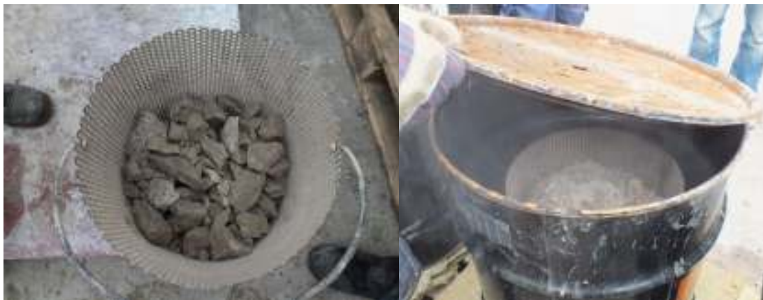
T.v. mindre stenar av bränd Komstadkalksten i nätspann. T.h. Samma kalksten efter torrsläckningen. Foto Helena Rosenberg.
